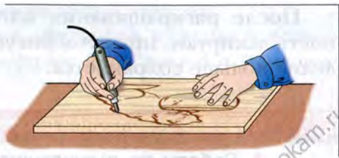
Рис. 76. Выжигание рисунка на фанере
