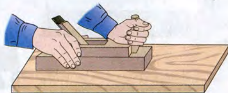
Рис. 36. Расположение заготовки при строгании с учётом наклона волокон древесины: а — правильное; б — неправильное
