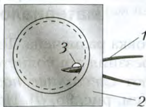
Рис. 114. Вырезание круга (а) и отверстия (б): 1 – слесарные ножницы; 2 – заготовка; 3 – технологическое отверстие
