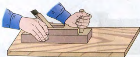
Рис. 36. Расположение заготовки при строгании с учётом наклона волокон древесины: а — правильное; б — неправильное
