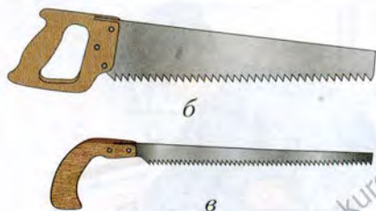
Рис. 23. Инструменты для пиления: a — лучковая пила; б — столярная ножовка; в — выкружная пила
