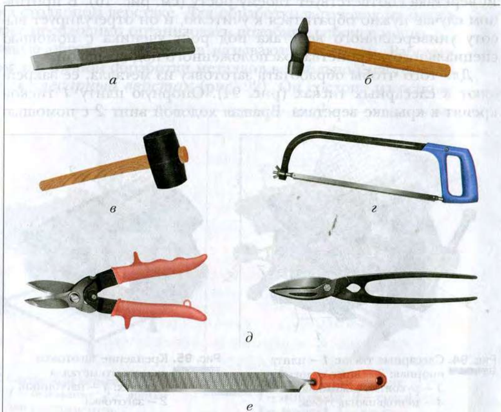
Рис. 96. Инструменты для ручной обработки тонколистового металла и проволоки: а – зубило; б – слесарный молоток; в – киянка; г – ножовка; д – ножницы по металлу; е – напильник
