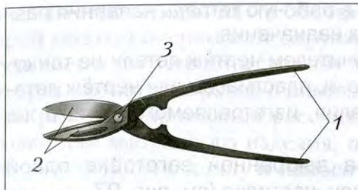
Рис. 112. Слесарные ножницы: 1 – ручки; 2 – лезвия; 3 – винт
